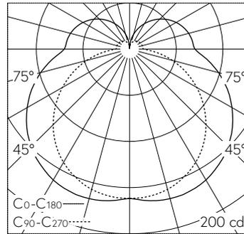
LED 3000 K 9.3 W 934 lm-h / CIE Flux 35 64 85 74 100 / B31 nach DIN 5040
