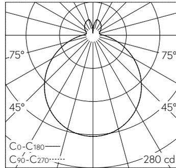
LED 3000 K 10.3 W 787 lm-h / CIE Flux 44 74 91 83 100 / B32 nach DIN 5040
