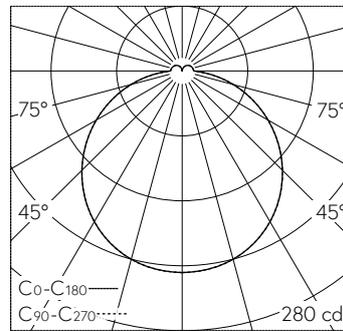
LED 3000 K 11 W 742 lm-h / CIE Flux 44 74 92 92 100 / A31 nach DIN 5040
