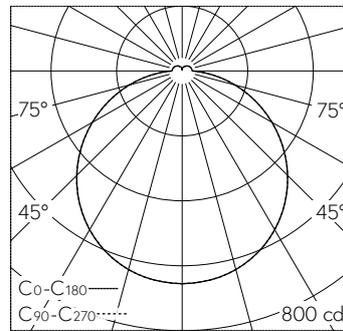
LED 4000 K 31.5 W 2542 lm-h / CIE Flux 44 75 92 93 100 / A41 nach DIN 5040
