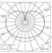
LED 3000 K 10.6 W 1116 / CIE Flux 23 48 73 54 100 / C12 nach DIN 5040
