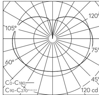
LED 4000 K 10.6 W 1188 / CIE Flux 23 48 73 54 100 / C12 nach DIN 5040
