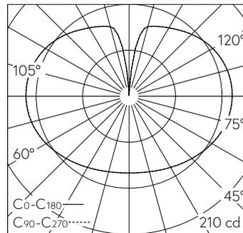
LED 2700 K 16.3 W 1767 lm-h / CIE Flux 22 46 72 50 100 / C12 nach DIN 5040
