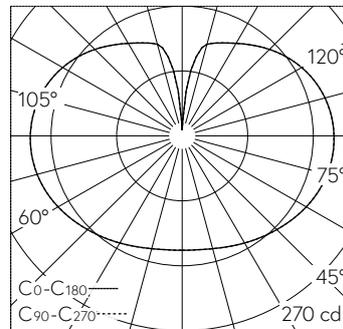
LED 2700 K 21.8 W 2347 lm-h / CIE Flux 22 47 72 52 100 / C12 nach DIN 5040
