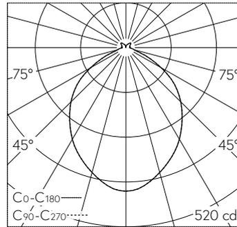
LED 3000 K 9.7 W 986 lm-h / CIE Flux 55 87 97 92 100 / A52 nach DIN 5040
