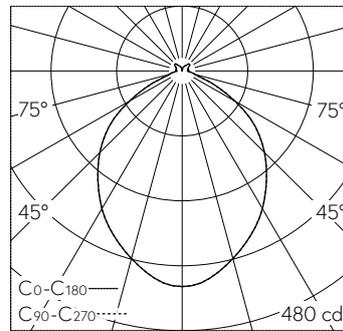
LED 2700 K 9.7 W 943 lm-h / CIE Flux 55 87 92 100 / A52 nach DIN 5040
