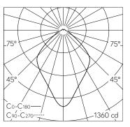
LED 3000 K 19 W 2080 lm-h / CIE Flux 59 88 97 94 100 / A51 nach DIN 5040
