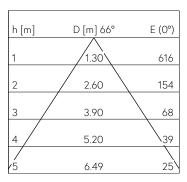
LED 3000 K 11.8 W 872 lm-h 66° / CIE Flux 69 89 97 100 100 / A60 nach DIN 5040
