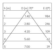
LED 3000 K 20 W 1455 lm-h 66° / CIE Flux 70 92 98 100 100 / A60 nach DIN 5040
