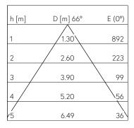
LED 3000 K 20 W 1135 lm-h 66° / CIE Flux 76 95 99 100 100 / A70 nach DIN 5040
