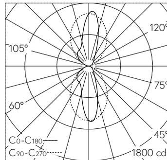
LED 3000 K 28.1 W 2571 lm-h / CIE Flux 61 87 98 50 100 / C54 nach DIN 5040
