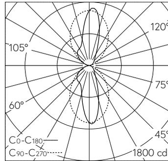
LED 4000 K 28.1 W 2678 lm-h / CIE Flux 61 87 98 50 100 / C54 nach DIN 5040
