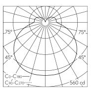
LED 3000 K 26.2 W 2288 lm-h / CIE Flux 38 68 88 80 100 / B31 nach DIN 5040
