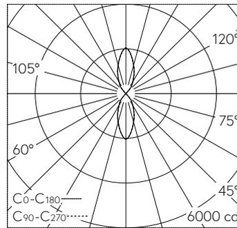
LED 3000 K 26.3 W 2520 lm-h / CIE Flux 97 100 100 50 100 / C84 nach DIN 5040
