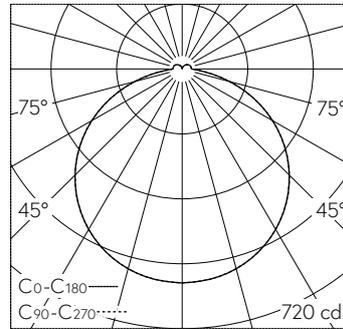
LED 3000 K 22.5 W 1939 lm-h / CIE Flux 45 76 94 94 100 / A41 nach DIN 5040
