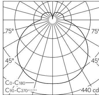
LED 3000 K 19.2 W 1770 lm-h / CIE Flux 39 68 88 79 100 / B32 nach DIN 5040
