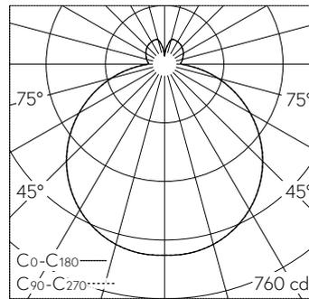
LED 3000 K 29 W 2465 lm-h / CIE Flux 43 73 91 83 100 / B32 nach DIN 5040
