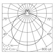
LED 3000 K 29 W 2263 lm-h / CIE Flux 46 76 94 89 100 / B43 nach DIN 5040
