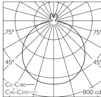
LED 3000 K 29 W 2263 lm-h / CIE Flux 46 76 94 89 100 / B43 nach DIN 5040
