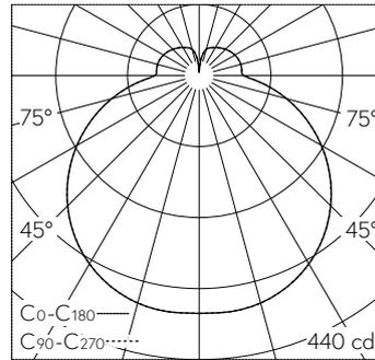
LED 2700 K 19.1 W 1744 lm-h / CIE Flux 39 68 88 79 100 / B32 nach DIN 5040
