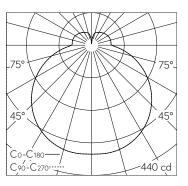
LED 3000 K 19.1 W 1770 lm-h / CIE Flux 39 68 88 79 100 / B32 nach DIN 5040
