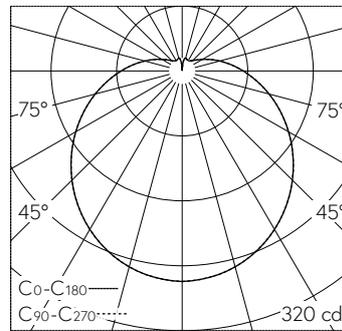
LED 2700 K 13.4 W 1189 lm-h / CIE Flux 37 65 85 82 100 / B31 nach DIN 5040
