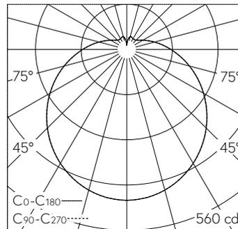
LED 2700 K 24.6 W 2188 lm-h / CIE Flux 37 65 85 81 100 / B31 nach DIN 5040
