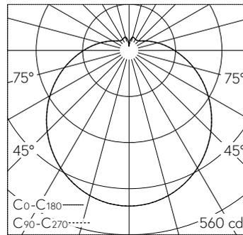
LED 3000 K 24.6 W 2214 lm-h / CIE Flux 37 65 85 81 100 / B31 nach DIN 5040
