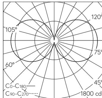
LED 4000 K 115 W 12945 lm-h / CIE Flux 13 38 67 50 100 / C11 nach DIN 5040
