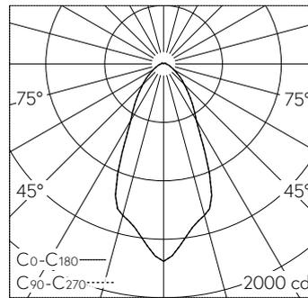
LED 3000 K 19.8 W 1724 lm-h / CIE Flux 73 91 97 96 100 / A61 nach DIN 5040
