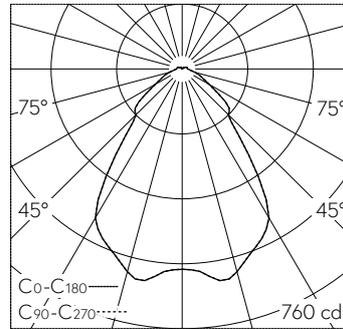
LED 3000 K 13.4 W 1178 lm-h / CIE Flux 66 88 96 95 100 / A61 nach DIN 5040
