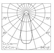
LED 3000 K 10.4 W 604 lm-h / CIE Flux 69 89 98 98 100 / A62 nach DIN 5040
