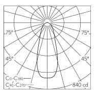
LED 3000 K 10.4 W 604 lm-h / CIE Flux 69 89 98 98 100 / A62 nach DIN 5040
