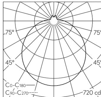
LED 2700 K 33.5 W 3371 lm-h / CIE Flux 42 71 89 87 100 / B31 nach DIN 5040
