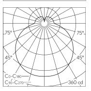
LED 2700 K 21 W 1423 lm-h / CIE Flux 39 68 88 78 100 / B32 nach DIN 5040
