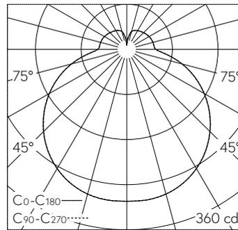
LED 2700 K 21 W 2073 lm-h / CIE Flux 39 68 88 78 100 / B32 nach DIN 5040
