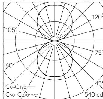
LED 3000 K 26.7 W 1948 lm-h / CIE Flux 47 79 95 50 100 / C43 nach DIN 5040
