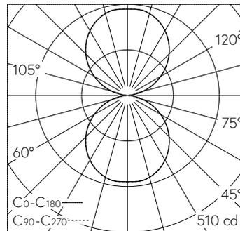
LED 3000 K 26.7 W 1860 lm-h / CIE Flux 48 79 96 50 100 / C43 nach DIN 5040
