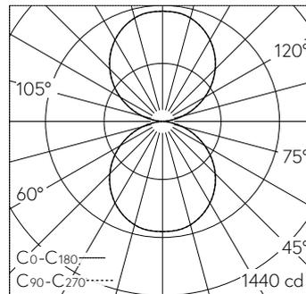
LED 3000 K 59 W 5223 lm-h / CIE Flux 48 79 96 50 100 / C43 nach DIN 5040
