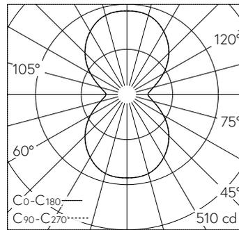
LED 3000 K 26.7 W 2148 lm-h / CIE Flux 41 69 87 50 100 / C33 nach DIN 5040
