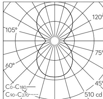
LED 3000 K 26.7 W 2137 lm-h / CIE Flux 41 69 87 50 100 / C33 nach DIN 5040
