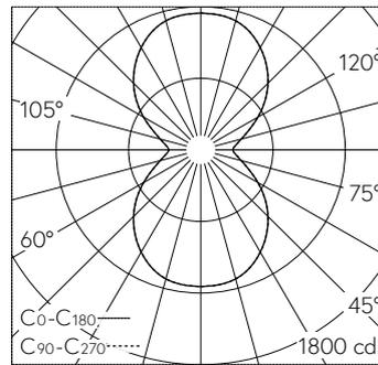
LED 3000 K 48 W 7610 lm-h / CIE Flux 41 70 87 50 100 / C33 nach DIN 5040
