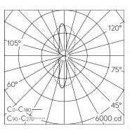
LED 3000 K 53 W 5910 lm-h / CIE Flux 60 86 97 50 100 / C53 nach DIN 5040
