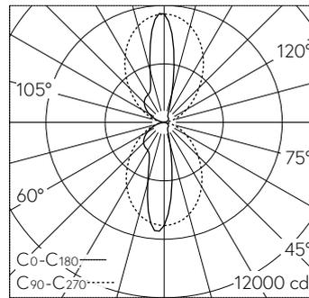
LED 3000 K 130 W 15595 lm-h / CIE Flux 59 85 97 50 100 / C53 nach DIN 5040
