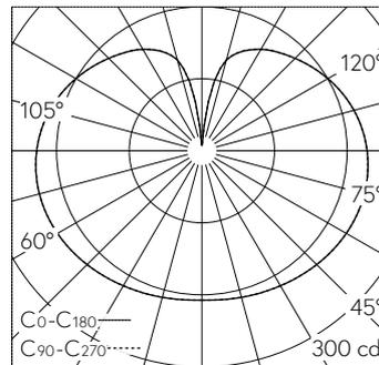
LED 3000 K 26.5 W 2632 lm-h / CIE Flux 24 49 74 54 100 / C12 nach DIN 5040
