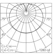
LED 4000 K 58.5 W 6348 lm-h / CIE Flux 27 52 76 59 100 / C21 nach DIN 5040
