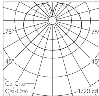
LED 4000 K 65 W 7664 lm-h / CIE Flux 25 50 75 56 100 / C12 nach DIN 5040
