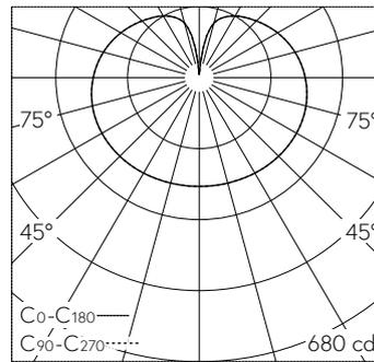
LED 4000 K 26.5 W 2955 lm-h / CIE Flux 25 50 75 56 100 / C12 nach DIN 5040
