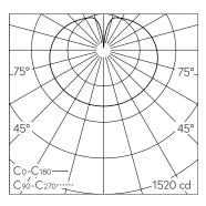
LED 3000 K 58.3 W 6612 lm-h / CIE Flux 25 51 75 56 100 / C12 nach DIN 5040
