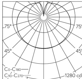
LED 4000 K 58.3 W 6348 lm-h / CIE Flux 27 52 76 59 100 / C21 nach DIN 5040
